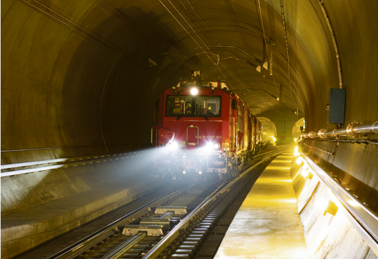
Treno di spegnimento e di soccorso TSS nella galleria di base del San Gottardo.
